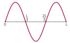
Figura 1 Profilo di un'onda stazionaria con quattro nodi.
