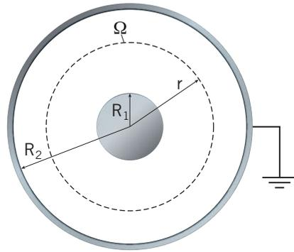
**Figura 1** La superficie gaussiana  $\Omega$  ha la forma di un cilindro di raggio  $r$ , coassiale alle armature del condensatore.
