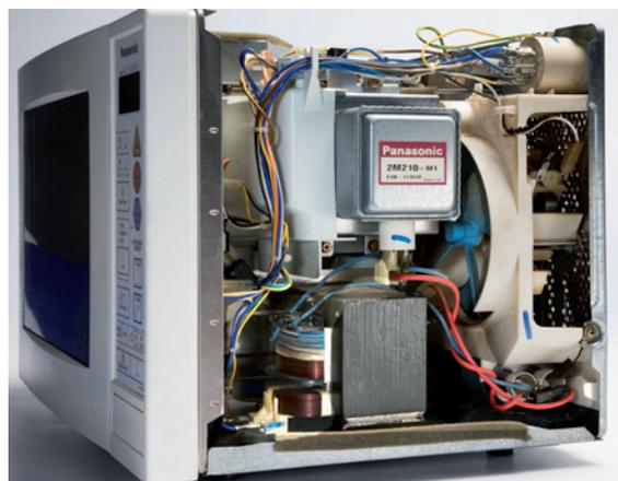
▲ **Figura 1** Il cuore del forno a microonde è il magnetron, un dispositivo che sinteticamente può essere descritto come un tubo in cui si muovono gli elettroni accelerati con conseguente emissione di radiazioni con una precisa frequenza.
