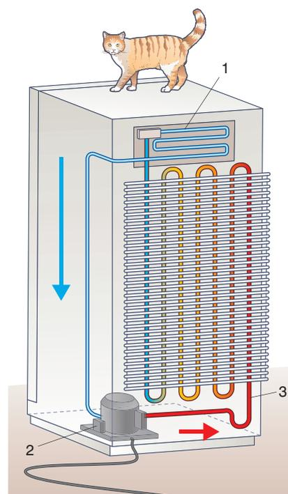
In conclusione, quella che avviene nel frigorifero è una trasformazione non spontanea dato che può avvenire solo a spese di un'altra forma di energia, l'energia elettrica. Questa invece è il frutto di una trasformazione spontanea, come per esempio la combustione del metano in una centrale termoelettrica oppure la caduta di una massa d'acqua in una centrale idroelettrica.
