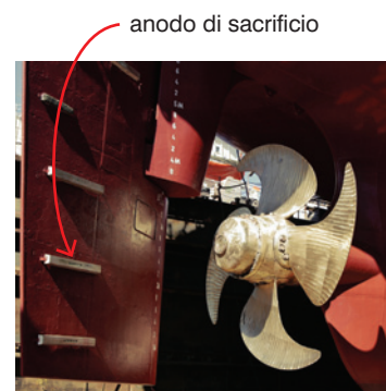
▲ Figura 5 L'anodo di sacrificio serve a proteggere dalla corrosione manufatti ferrosi come per esempio serbatoi, tubature interrate, gli scaldabagni domestici e anche gli scafi delle navi.
