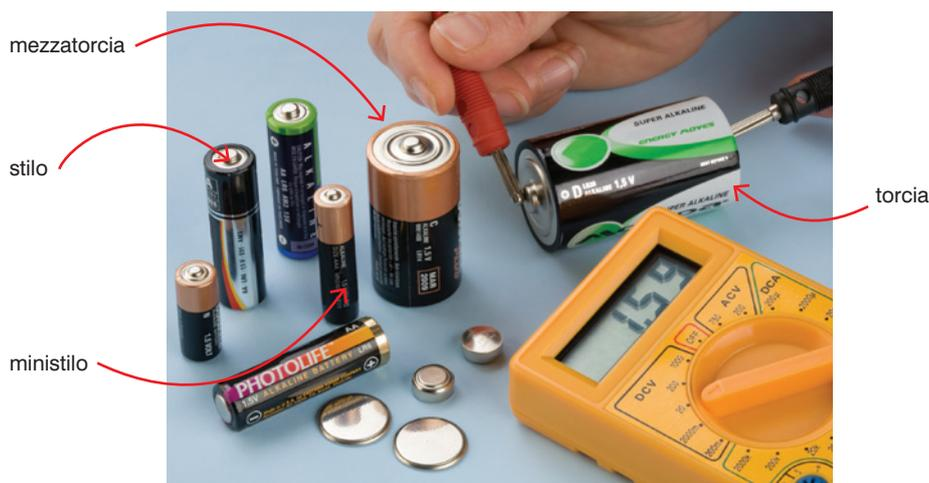
◀ **Figura 1** Le pile dello stesso tipo, per esempio le cosiddette *pile alcaline*, hanno tutte lo stesso voltaggio indipendentemente dalle loro dimensioni. Una pila più grande contiene una maggiore quantità di reagenti e quindi può erogare una maggiore quantità di elettricità. Se la pila non è ancora stata utilizzata ha un voltaggio di solito leggermente superiore a quello dichiarato.
