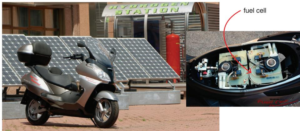
◀ **Figura 11** Affinché i veicoli elettrici passino dalla fase di sperimentazione alla produzione di serie occorre superare ancora alcuni problemi; per esempio, è necessario creare la rete distributiva di un combustibile che è gassoso e che non è conveniente rendere liquido a causa dell'alto costo richiesto.
