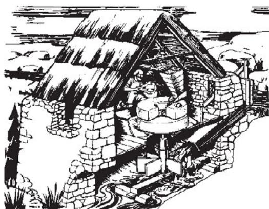
Nel mulino orizzontale l'acqua aziona una ruota il cui asse verticale è direttamente collegato alla macina.
