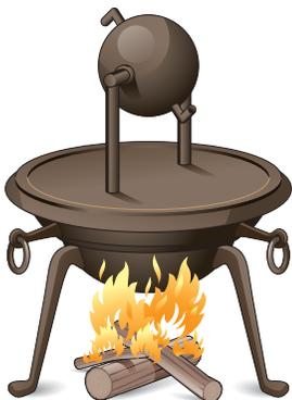
Nel I secolo a.C. Erone d'Alessandria inventò un congegno a reazione che chiamò «eolipila». Essa sfruttava getti di vapore in uscita da due ugelli.
