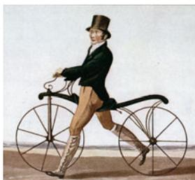
Una draisina. La ruota anteriore può sterzare, ma è ancora l'azione dei piedi sul terreno a far avanzare e frenare il veicolo.
