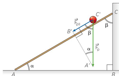
**Figura 2.** Relazioni tra le grandezze che caratterizzano il piano inclinato e le componenti della forza-peso di un corpo poggiato su di esso.
