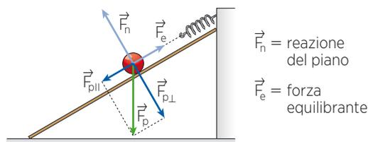
**Figura 1.** La componente parallela al piano della forza-peso è equilibrata da  $\vec{F}_e$ , che dipende dalla lunghezza  $\ell$  del piano e dalla sua altezza  $h$ .
