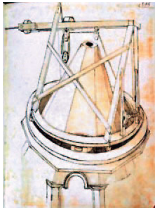
Gru girevole della lanterna, disegno di Bonaccorso Ghiberti.
