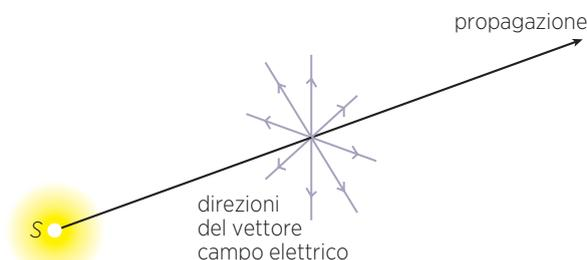
**Figura 2.** La luce non è di solito polarizzata, perché formata da onde elettromagnetiche i cui campi elettrici oscillano su piani orientati a caso in tutte le direzioni.
