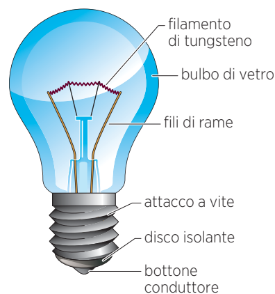
Schema di una lampadina a incandescenza.
